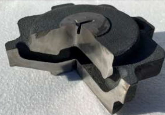
КОРПУС КОНДЕНСАТООТВОДЧИКА отливка ВЧ40 1,27 кг
