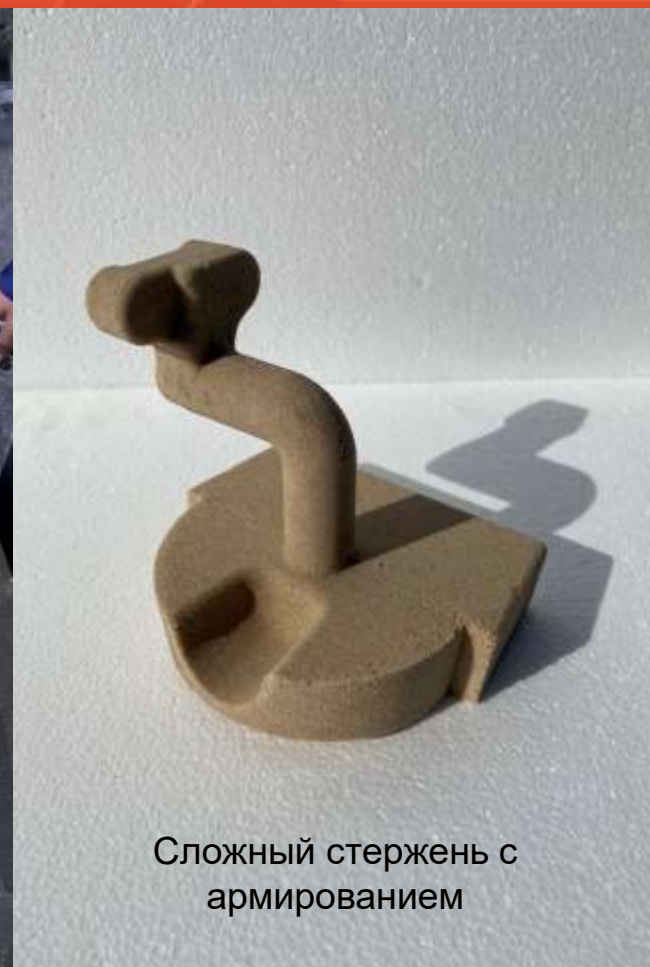
Форма ХТС с печатным стержнем
