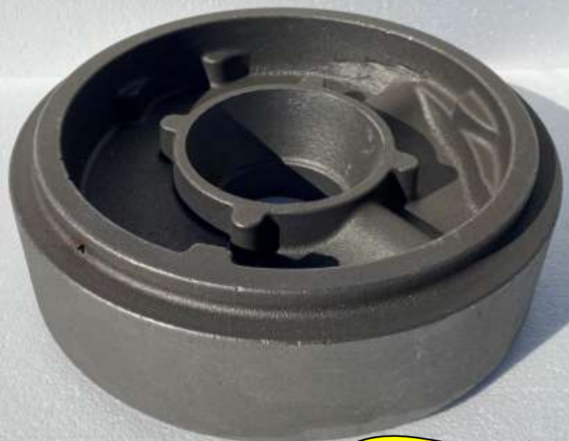
КОРПУС НАСОСА деталь СЧ20 12,7 кг
