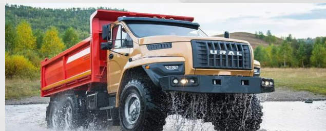
Самосвал с трехсторонней разгрузкой
