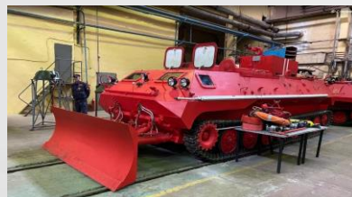
ПОЖАРНАЯ МАШИНА МТ-ЛБУ-ГПМ-10
